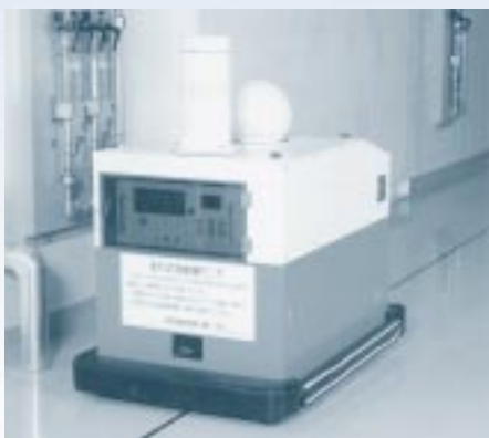
Robot de vigilància radioactiva utilitzat en les instal·lacions nuclears japoneses.
