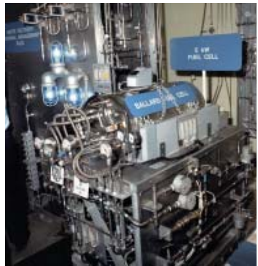
Una de les primeres cèl·lules PEM de 5 kW dissenyades per Ballard per fer funcionar un autobús, actualment en el museu de la NASA. Comparem-la amb una de moderna (pàgina 14).
