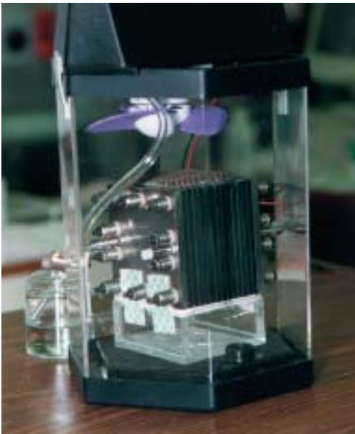
Cèl·lula de combustible de metanol que aprofita l'hidrogen d'aquest líquid per produir electricitat en una aplicació didàctica.
