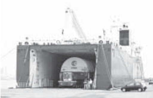
Transport d'hidrogen líquid criogènic. Aquest sistema és complex i té pèrdues, de moment inevitables. Tanc destinat als cohets Arienne.
