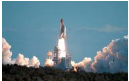
Llançament del transbordador espacial. Per posar en òrbita aquest giny a 300 km d'alçada es tarda uns 45 minuts i es cremen un 2 milions de litres d'hidrogen i oxigen líquid.
