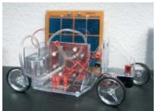
Detall de la cèl·lula de combustible del cotxe amb el dipòsit d'aigua i placa fotovoltaica.
