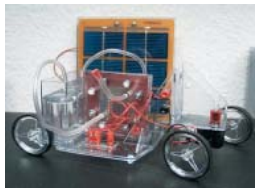
Detalle de la célula de combustible del coche con el depósito de agua que con energía fotovoltaica se convierte en hidrógeno.
