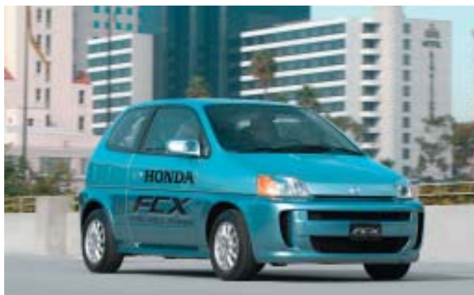
Vehículo de hidrógeno de la casa Honda decido en el 2003 al gobierno californiano para demostrar la viabilidad de esta tecnología. Equipado con una pila de combustible Ballard de 78 kW, una autonomía de 355 km y un depósito de 3,75 kg de hidrógeno a 350 bares.
