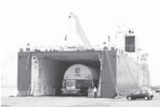
Transporte de hidrógeno líquido criojénico. Este sistema es complejo y tiene pérdidas, de momento inevitables. Tanques destinados a los cohetes Ariane.
