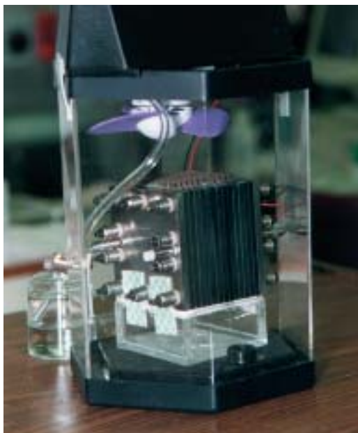
Célula de combustible de metanol que aprovecha el hidrógeno de este líquido para producir electricidad en una aplicación didáctica.
