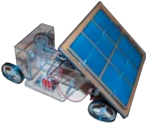
Detalle de la placa fotovoltaica con la cual se genera electricidad que sirve para recargar el tanque de hidrógeno del coche, con el cual, una vez lleno, a través de la célula de combustible se hace girar el motor eléctrico que mueve.
