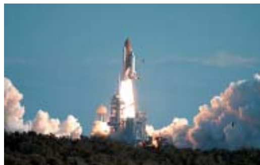
Lanzamiento del transbordador espacial. Para poner en órbita este ingenio a 300 km. de altura se tarda unos 45 minutos y se queman unos 2 millones de litros de hidrógeno y oxígeno
