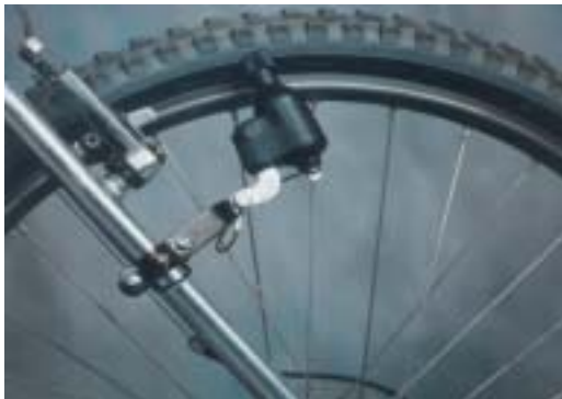
La dinamo de la bicicleta s'hauria d'anomenar magneto ja que l'origen del corrent és el magnetisme permanent de l'imant, mentre que el substantiu dinamo s'aplica quan el magnetisme el produeix un corrent elèctric.
