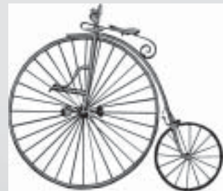
Bicicle del 1855, la roda del davant podia tenir fins a 2 m.
