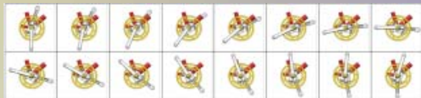
Seqüència dels moviments del pedaleig amb el plat de Rotor.
