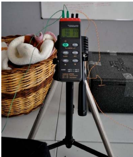
Data logger con las 4 sondas de temperatura usado durante el estudio.
